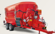
VM3 Twin essieux balancier suiveur et forçable avec double effet tracteur.
