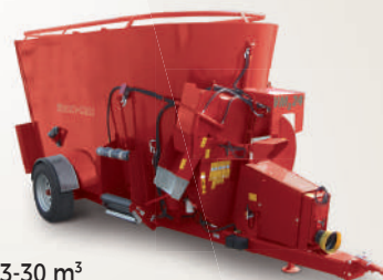
VM3-30 m³ (altezza 305 cm + 15 cm di anello contenimento).
