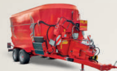
VM3 Twin con sistema di bilanciamento a doppio asse con asse sterzante posteriore
