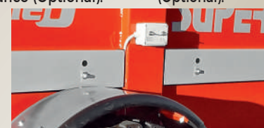
Il comando ripetitore laterale di alzata del portello e rotazione del tappeto posto sul lato della macchina permette di ottimizzare le operazioni di carico. (Optional).
