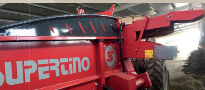
Scarico di serie a destra con regolazione idraulica.
