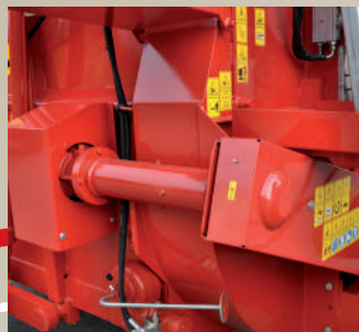
Rotore con sicurezza a frizione "NON-STOP" (pattinamento in caso di corpi estranei).
