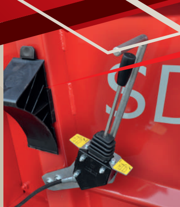
Leva di comando laterale per la pala di carico (Optional).
