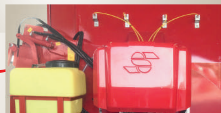
Il kit anti-polvere per l'abbattimento polvere é composto da un serbatoio da 50 lt e da 4 nebulizzatori sopra il rotore. (Optional).
