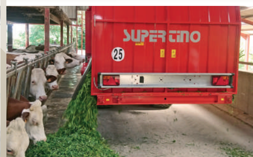
Scarico con dosatore a 3 rotori e tappeto bilaterale. (Optional).
