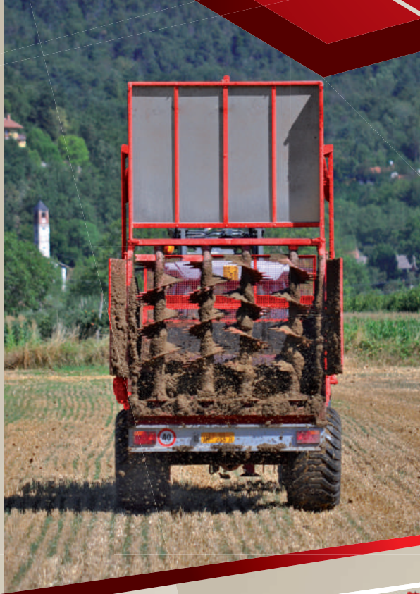
Il tappeto quattro catene 2+2 con tiraggio indipendente (optional).
